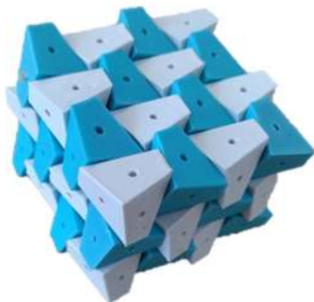
Рис. 1. Общий вид самозаклинивающейся структуры из скошенных кубов
