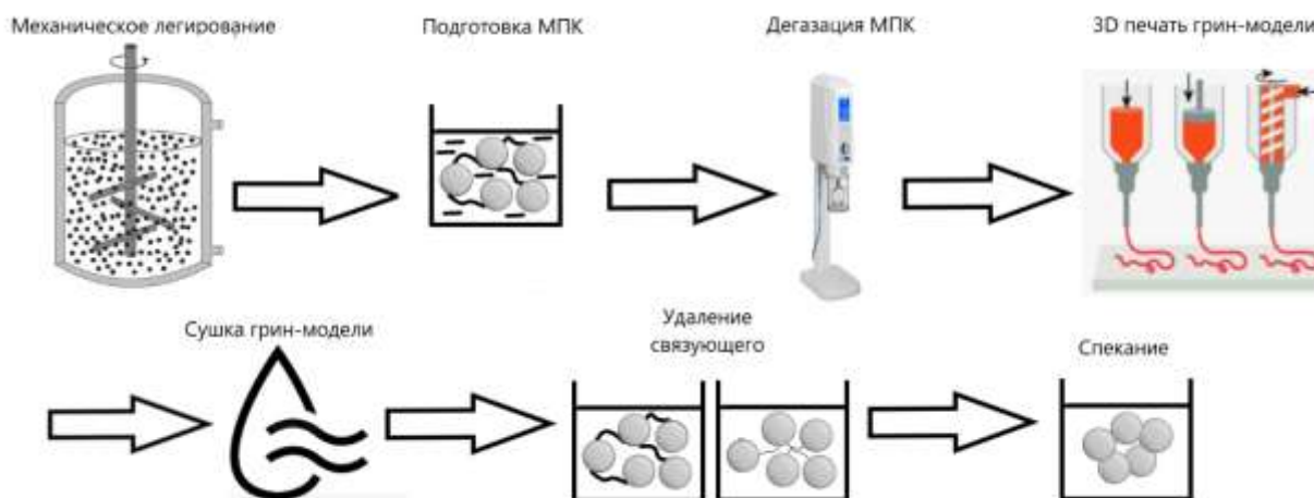
Рис. 1. Схема реализации метода непрямого получения металлических изделий системы Co-Ni-Al с применением экструзионной 3D-печати из металлополимерной пасты
