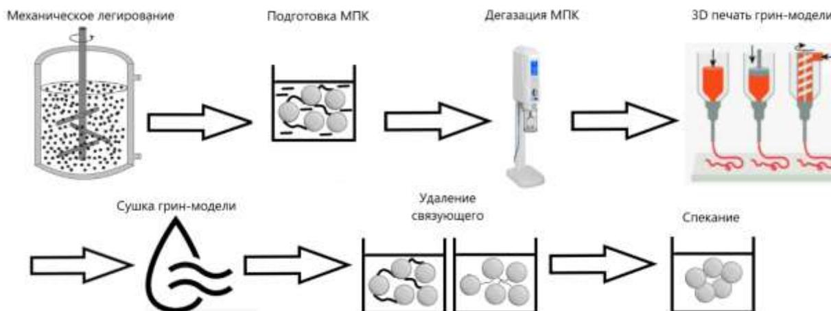
Рис. 1. Схема реализации метода непрямого получения металлических изделий системы Co-Ni-Al с применением экструзионной 3D-печати из металлополимерной пасты
