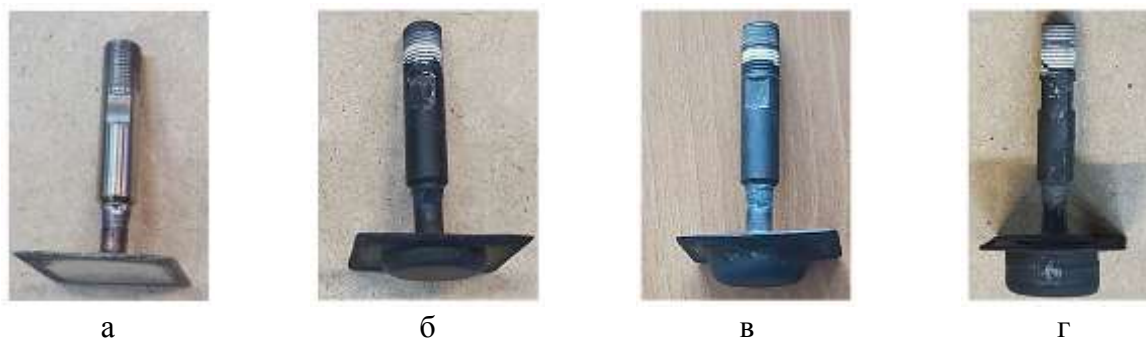
Рис. 1. Образцы до (а) и после СПФ при T=850°C на глубину: (б)– H = 5 мм; (в) – H = 10 мм; (г) – H = 15 мм.
