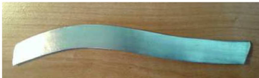
Рис.1. Накладка для лопатки из углепластика полученная комбинированным прессованием
